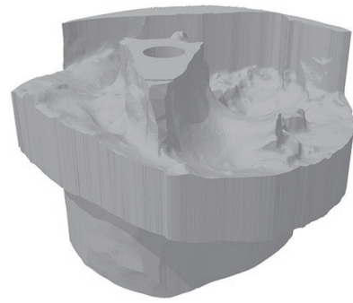
写真 70 三次元情報による棟持柱支持具データ作成
