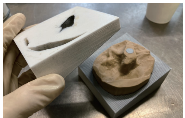
写真 72 シリコン樹脂製支持具の脱型
