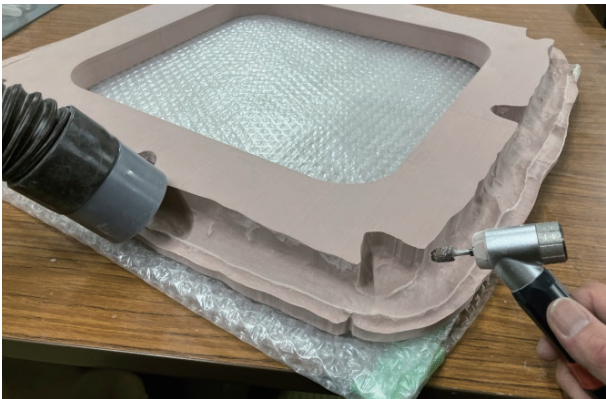
写真 63 切削品の微調整
